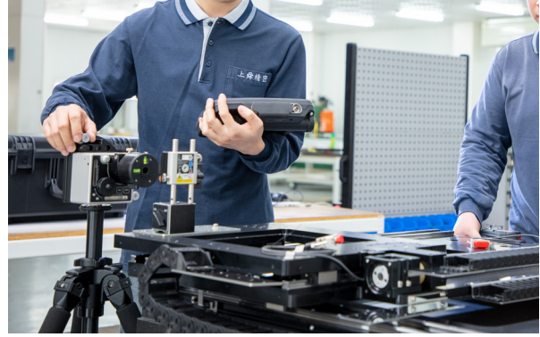
以 XK10 校準雷射系統對精密線性平台進行驗證
