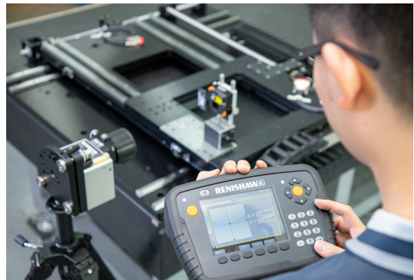
XK10 無線顯示單元 — 取得和記錄量測值並顯示即時讀數，以使用戶即時調整
