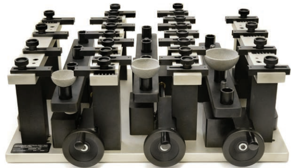
客製化夾具用於一次夾持多種尺寸大小的零件系列。
