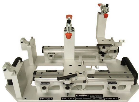
Guide lineari permettono l'utilizzo di pezzi con lunghezze variabili.
