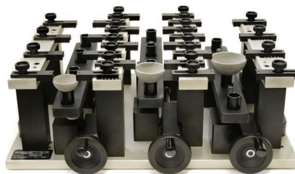
Elemento personalizzato per fissare contemporaneamente più pezzi di dimensioni diverse.
