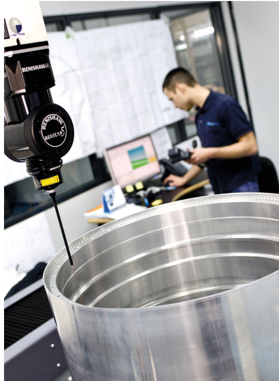
REVO durante la scansione di un foro di grandi dimensioni su un componente per il settore aerospaziale
